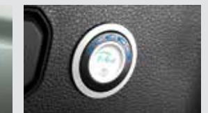
LPG 스위치 LPG 충전량 표시 및 LPG와 가솔린 전환
