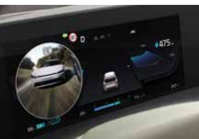
후측방 모니터 방향 지시등 스위치를 조작하면 해당 방향의 후측방 영상을 클러스터에 표시해 줍니다.
