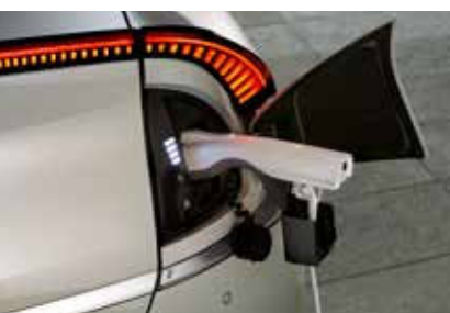
실외 V2L 커넥터 차량 충전구와 연결하여 전자기기를 보다 편리하게 사용할 수 있게 하였습니다.
