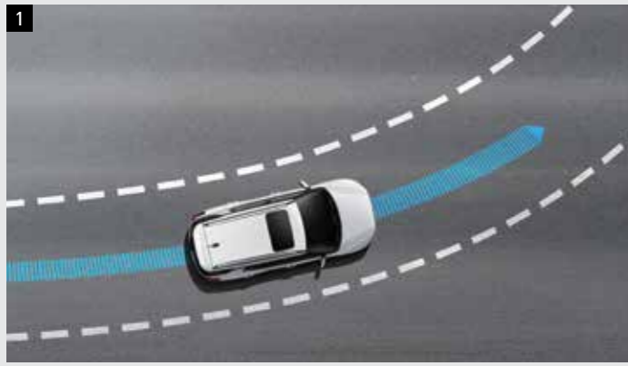
1 중앙 차선 유지 보조 CLKA (Centering Lane Keeping Assist) 주행 시 스스로 스티어링 휠을 작동하고 차선을 중앙으로 유지하여 주행할 수 있게 하는 시스템입니다.
