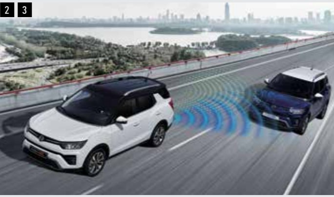
2 차선 변경 경고 LCW (Lane Change Warning) 차량 후측방에서 빠른 속도로 접근하는 70m 이내 차량을 감지하여 아웃사이드미러의 경보등을 점멸시키고, 경고음을 울립니다.
