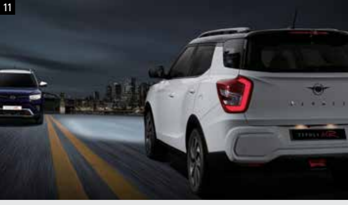
11 스마트 하이빔 SHB (Smart High Beam) 앞 차량의 리어컴비 램프 및 맞은편 차량의 헤드램프, 주변 밝기 상태를 감지하여 상향 또는 하향등으로 자동 전환되는 기능입니다.
