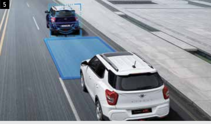
5 안전 거리 경고 SDW (Safety Distance Warning) 주행 중 운전차량 속도 대비 전방 차량과 안전거리 미 확보 시 경보를 통해 알려줍니다. (안전거리는 운전차량 속도에 따라 유동적으로 변동됨)
