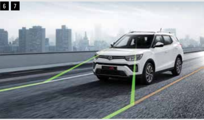
6 차선 이탈 경고 LDW (Lane Departure Warning) LKA가 작동 중임에도 불구하고 주행차량이 차선을 이탈하려고 할 때 운전자에게 경고를 주는 시스템입니다.
