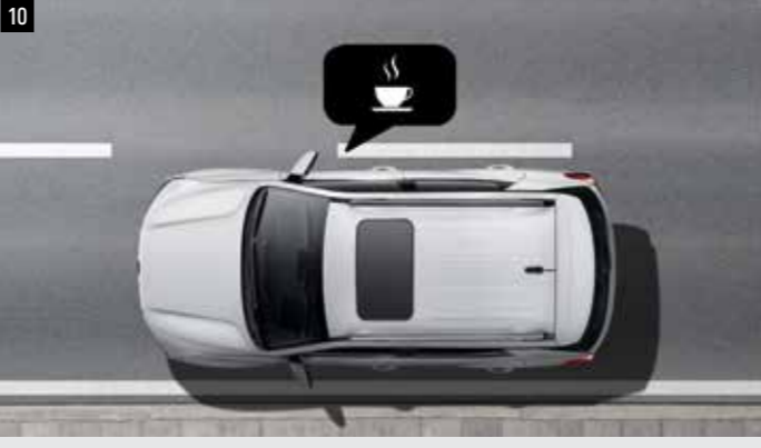
10 부주의 운전 경고 DAW (Driver Attention Warning) 차량 주행 패턴을 분석하여 부주의하다고 판단하면 휴식을 권유하는 메시지와 함께 경고음을 발생시켜 운전자에게 휴식을 권하는 안전 시스템입니다.
