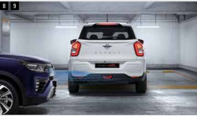
8 후측방 접근 경고 RCTW (Rear Cross Traffic Warning) 주차공간이나 후진 주행 시 센서가 차량에 접근하는 물체를 감지하면 운전자에게 위험을 경고하여 미연에 사고를 방지할 수 있습니다.
