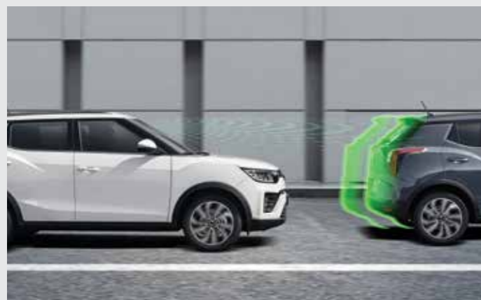
앞차 출발 경고 FVSW (Front Vehicle Start Warning) 정차 중 앞차 출발을 운전자가 인지하지 못했을 때 팝업과 경고음으로 전방 차량 출발을 알려줍니다.
