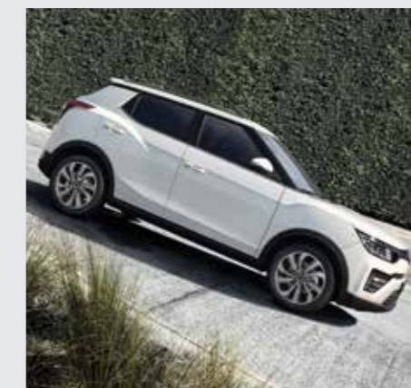
경사로 저속 주행장치 가변형 HDC (Hill Descent Control) 급경사 주행 시, 자동 저속 주행 장치가 작동되어 급가속 되지 않도록 속도를 조절해 줍니다.
