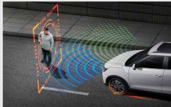
긴급 제동 보조 AEB(Autonomous Emergency Braking) 주행 중 전방충돌이 예상될 경우 자동으로 제동 브레이크를 작동시켜 사고를 미연에 방지해줍니다.
