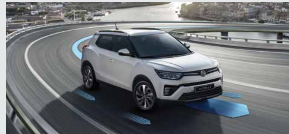
차량전복 방지장치 ARP(Anti-Rollover Protection) 고속주행 중 급선회 구간에서 각 바퀴의 브레이크와 엔진출력을 조절하여 차량의 전복을 방지시켜 줍니다.
