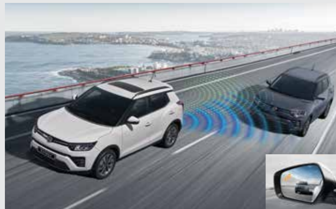
차선 변경 경고 LCW(Lane Change-Collision Warning) 차량 후측방에서 빠른 속도로 접근하는 70m 이내 차량을 감지하여 아웃사이드미러의 경보등을 점멸시키고, 경고음을 울립니다.
