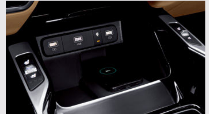
스마트폰 무선충전 시스템 무선 충전 기능을 지원하는 스마트폰을 별도의 케이블 연결 없이 충전 패드 위에 올려두는 것만으로 편리하게 충전 가능한 첨단 편의 장치입니다. ※ 스마트폰 기종에 따라 별도의 충전 패드 또는 충전 커버가 필요할 수 있으며, 별도 수신장치 장착 불가 기종은 이용이 어려울 수 있습니다.
