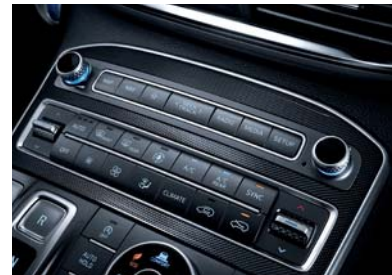
리어컴비레프트 듀얼 풀오토 에어컨 (미세먼지 센서, 오토디포그, 공기 청정 모드)
