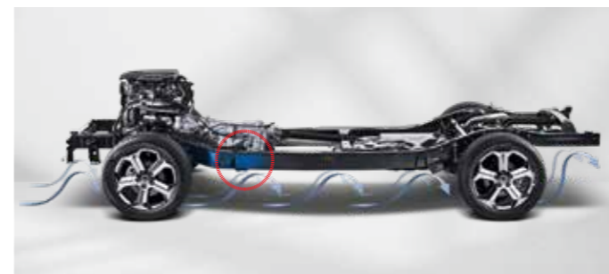
초고장력 4중 구조 프레임 바디 초고강도 기가 스틸이 적용된 초고장력 4중 구조 프레임은 엔진과 현가장치가 프레임에 장착되어 노면 소음과 엔진 소음을 차단하고 험로, 과속방지턱 등에서 탑승객에게 전달되는 노면 충격을 차단합니다. 특히 프론트 범퍼빔은 세계 최초 1.5기가 파스칼급 초고강도강을 적용하여 정면충돌 시 차량에 가해지는 충격을 최대한 흡수, 탑승객을 보호합니다.
