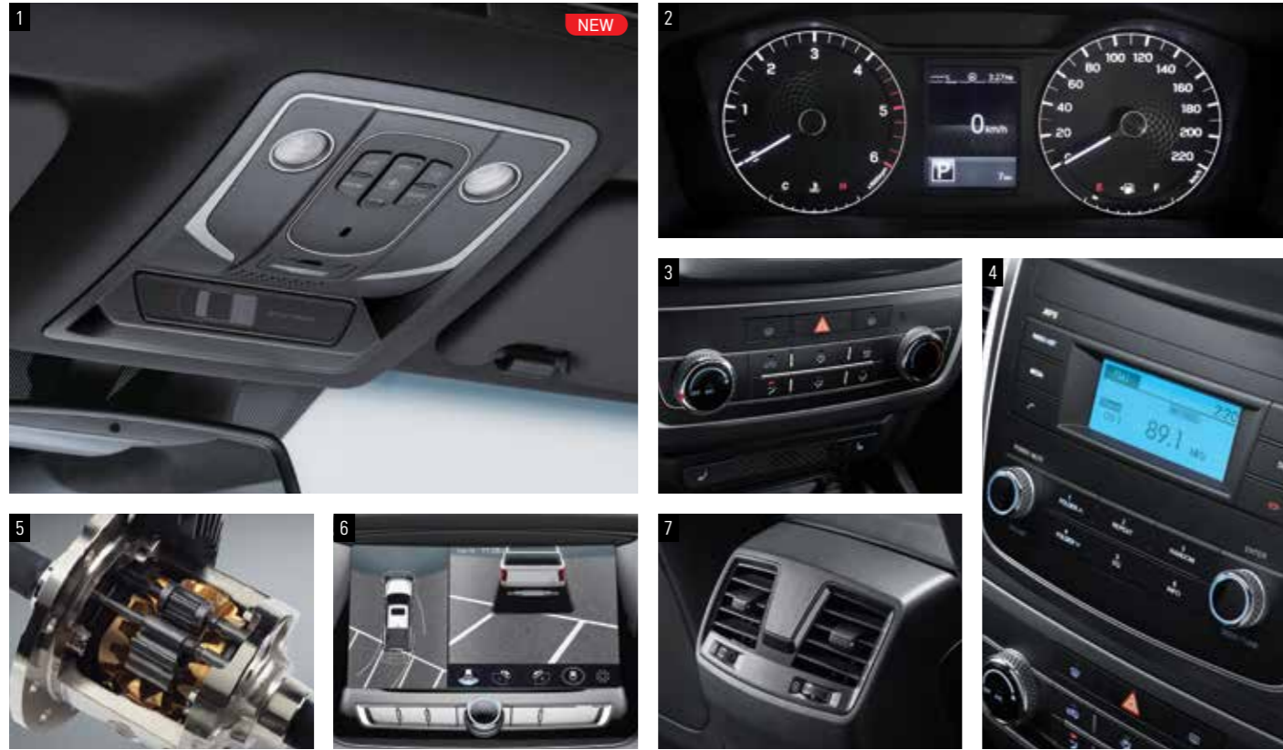
1. 뉴 오버헤드 콘솔 & LED 룸램프 2. 슈퍼비전 클러스터(3.5인치 모노 LCD) 3. 메뉴얼 에어컨 4. MP3 오디오 5. LD 시스템 6. 3D AVM(3D Around View Monitor) 7. 2열 센터콘솔 에어벤트
