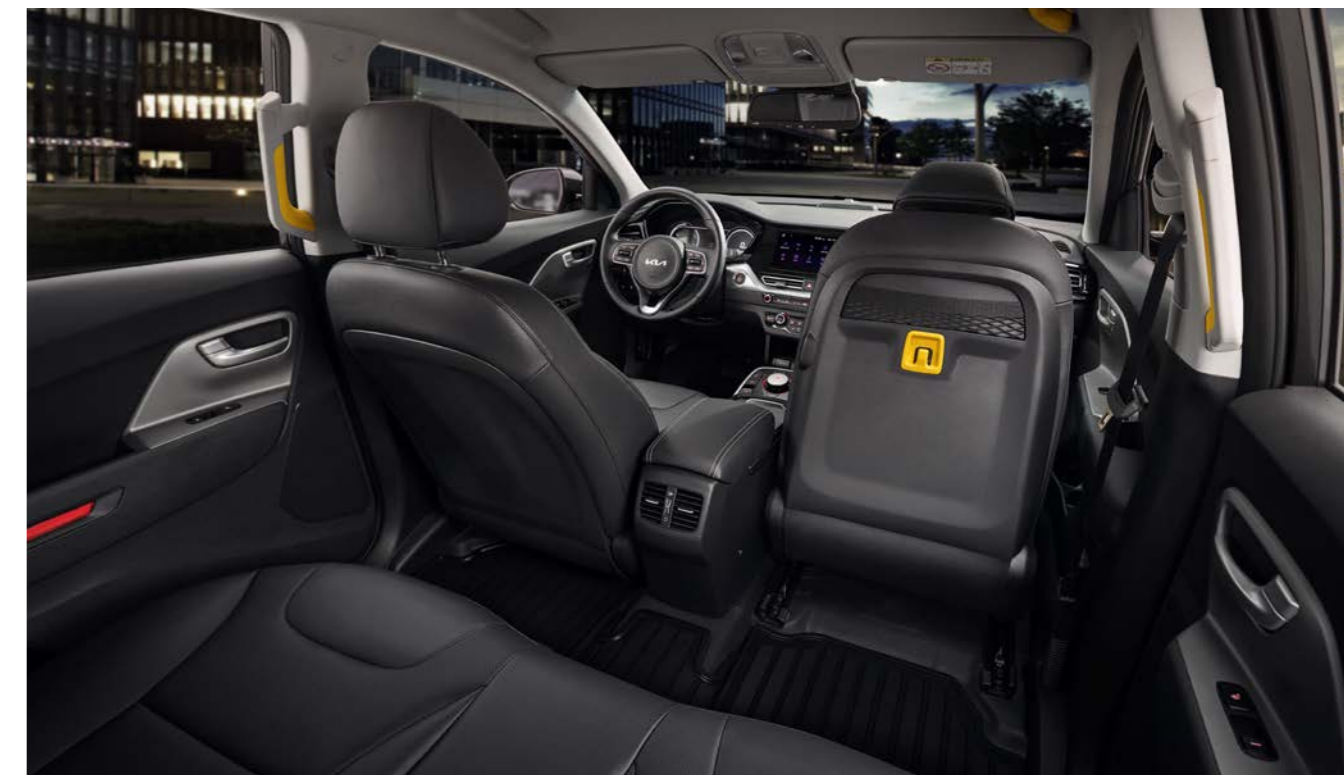
2열 시트벨트 버클 조명 (택시 모델 限) / 2열 도어 리플렉터 시트벨트 버클 주변 LED 조명으로 시인성을 높여 탑승자의 벨트 체결에 도움을 주고, 2열 도어 암레스트에 적용된 리플렉터가 탑승객의 안전한 승하차를 보조합니다.
