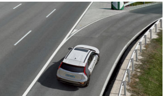
내비게이션 기반 스마트 크루즈 컨트롤 (진출입로) ※ EV 전용 고속도로 및 자동차 전용도로 진출입로 주행 시 속도를 적절히 조절하여 안전한 주행을 도와줍니다. 이후 진출입로 구간을 지나면 원래 설정한 속도로 주행합니다.
