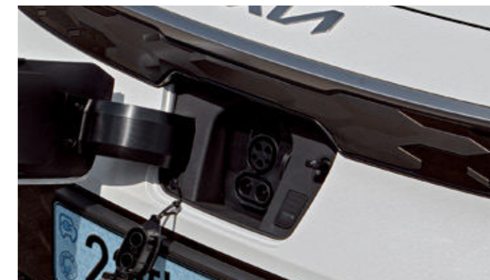
충전구 전면에 위치한 충전구를 통해 완속 충전과 급속 충전이 가능합니다. 인디케이터를 적용하여 차량의 외부에서 충전 상태를 확인할 수 있습니다.
