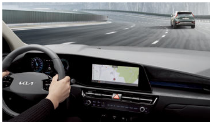
내비게이션 기반 스마트 크루즈 컨트롤 (고속도로/자동차 전용도로 내 안전구간/곡선로) 고속도로 / 자동차 전용도로 주행 시 도로 상황에 맞춰 안전한 속도로 주행하도록 도와줍니다. 안전속도 구간과 곡선 구간에서는 진입 전에 속도를 자동으로 줄여주고 이후 안전속도 구간과 곡선 구간을 지나면 원래 설정한 속도로 주행합니다.
