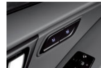
운전자세 메모리 시스템 (운전석 시트, 아웃사이드 미러)
