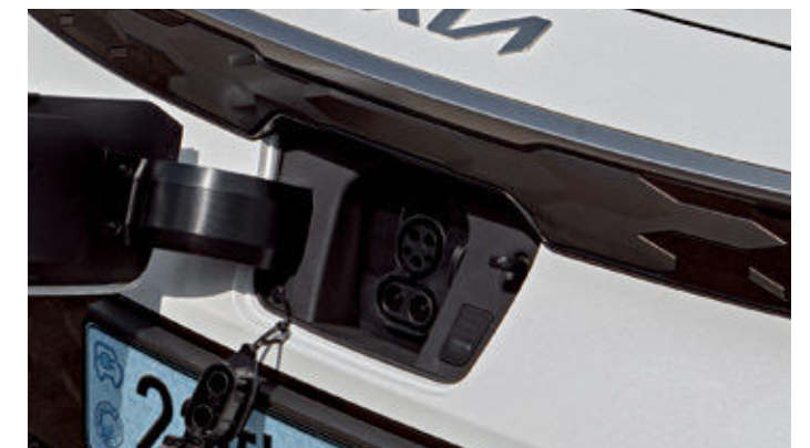
충전구 전면에 위치한 충전구를 통해 완속 충전과 급속 충전이 가능합니다. 인디케이터를 적용하여 차량의 외부에서 충전 상태를 확인할 수 있습니다.
