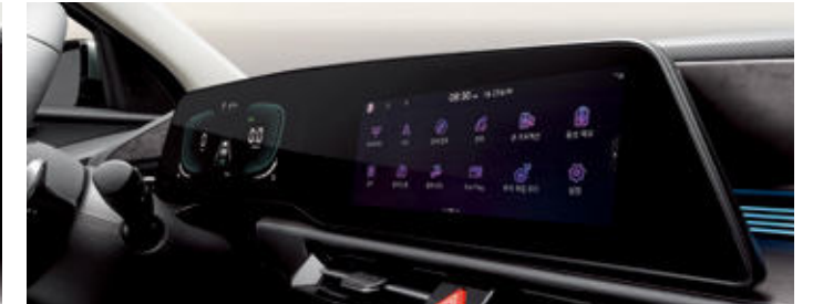
슈퍼비전 클러스터 (4.2인치 칼라 TFT LCD) & 10.25인치 내비게이션
