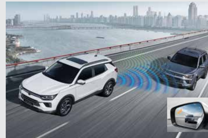
차선 변경 경고 LCW (Lane Change-Collision Warning) 차량 후측방에서 빠른 속도로 접근하는 70m 이내 차량을 감지하여 아웃사이드미러의 경고등을 점멸시키고, 경고음을 울립니다.
