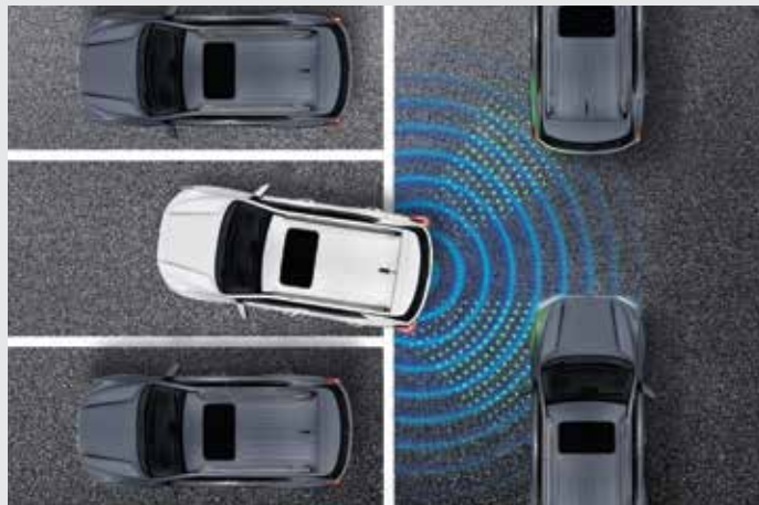
후측방 접근 경고 RCTW (Rear Cross Traffic Warning) 주차공간이나 후진 주행 시 센서가 차량에 접근하는 물체를 감지하면 운전자에게 위험을 경고하여 미연에 사고를 방지할 수 있습니다.
