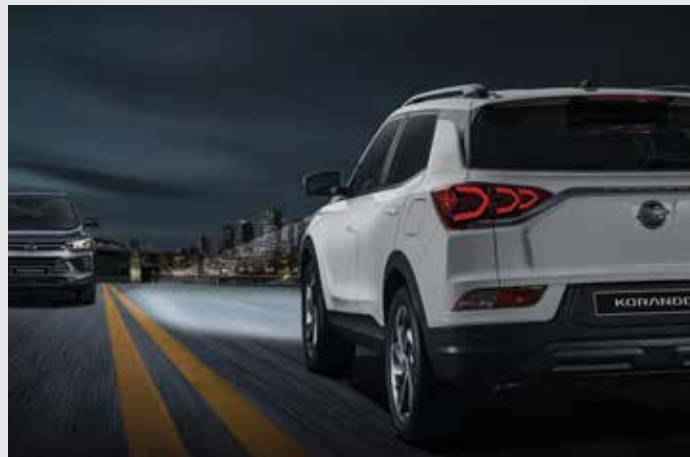
스마트 하이빔 SHB (Smart High Beam) 앞 차량의 리어컴비 램프 및 맞은편 차량의 헤드램프, 주변 밝기 상태를 감지하여 상향 또는 하향등으로 자동 전환되는 기능입니다.
