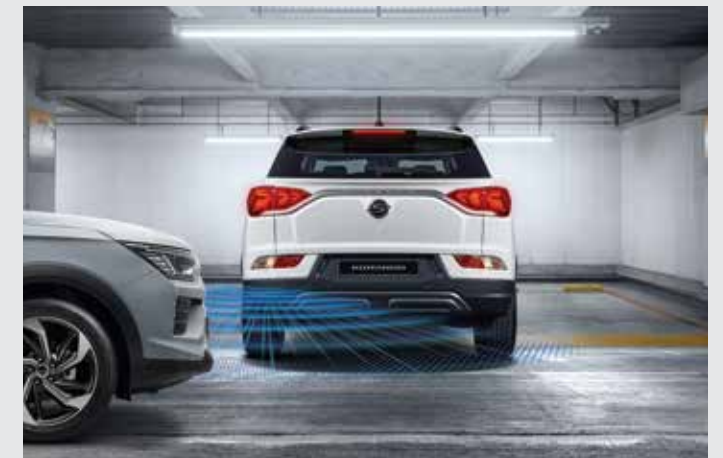
후측방 접근 충돌 보조 RCTA (Rear Cross Traffic-Collision Assist) 주차 공간이나 후측방 접근 경고 중 차량 충돌위험 예상 시 긴급 제동하여 차량을 멈춰줍니다.
