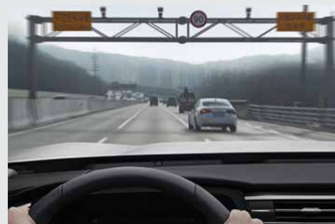
고속도로 안전 속도 제어 SSA (Safety Speed Assist) 고속도로 주행 시 내비게이션 정보(고정식/이동식/구간 단속정보)와 차선 중심 추종 제어(횡방향 제어) 기술을 바탕으로 고속도로 주행을 보조해 줍니다. (*내비게이션 선택 시 사용 가능)
