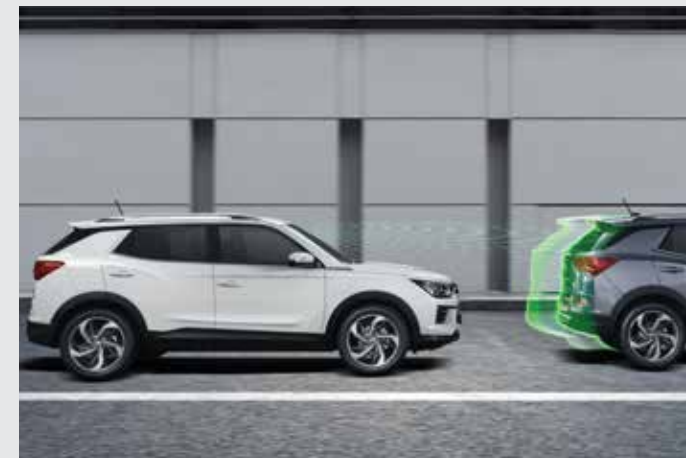
앞차 출발 경고 FVSW (Front Vehicle Start Warning) 정차 중 앞차 출발을 운전자가 인지하지 못했을 때 팝업과 경고음으로 전방 차량 출발을 알려줍니다.
