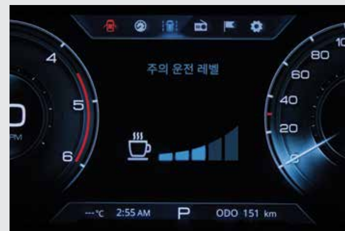
부주의 운전 경고 DAW (Driver Attention Warning) 차량 주행 패턴과 전방 카메라에 수집된 정보를 분석하여 주의 운전 레벨 및 경고를 알려줍니다.
