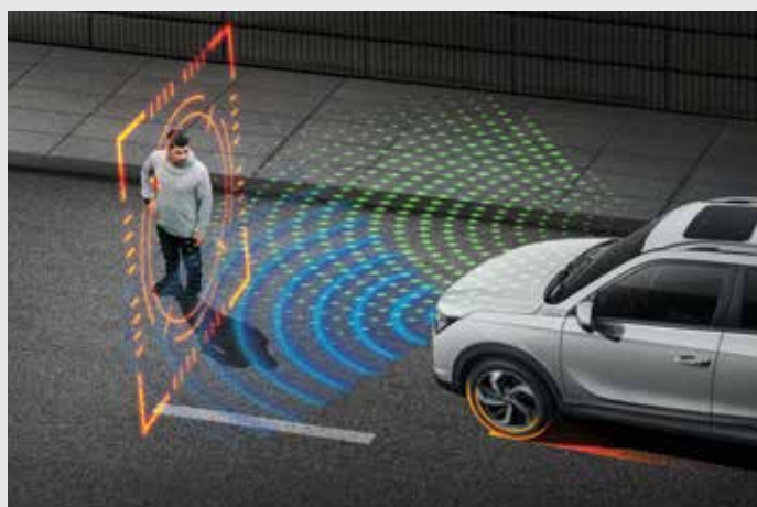
긴급 제동 보조 AEB (Autonomous Emergency Braking) 주행 중 전방충돌이 예상될 경우 자동으로 제동 브레이크를 작동시켜 사고를 미연에 방지해줍니다.
