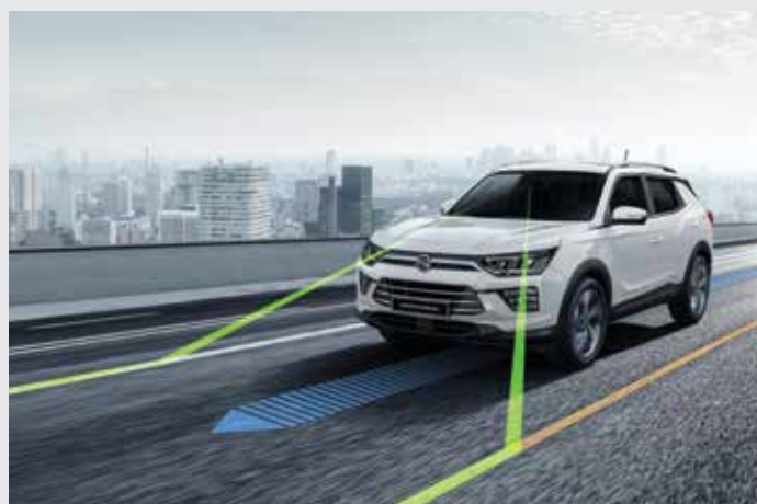
중앙 차선 유지 보조 CLKA (Centering Lane Keeping Assist) 주행 시 스스로 스티어링 휠(EPS)을 작동하고 차선을 중앙으로 유지하여 주행할 수 있게 하는 시스템입니다.
