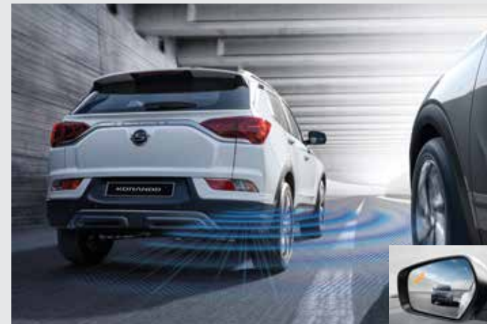
후측방 경고 BSW (Blind Spot-Detection Warning) 후방 사각지대에 근접되어 있는 차량을 감지하여 아웃사이드미러의 경고등이 점등합니다.
