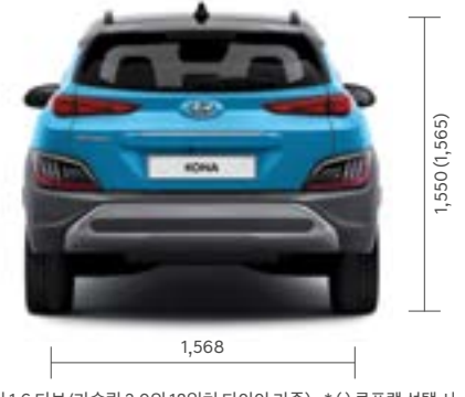
* 단위: mm (이미지 및 윤거 수치는 스마트스트림 가솔린 1.6 터보/가솔린 2.0의 18인치 타이어 기준) * ( ) 루프랙 선택 시 * N Line은 전장 4,215mm, 전고 1,560 (루프랙 선택 시 1,570)mm
