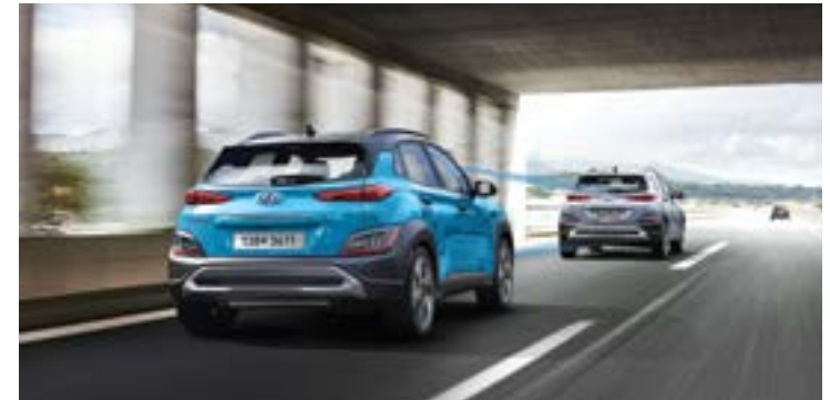
후방 교차 충돌방지 보조 후진 중 좌/우측에서 다가오는 차량과 충돌 위험이 감지되면 경고를 해줍니다. 경고 후에도 충돌 위험이 높아지면 자동으로 제동을 도와줍니다.
