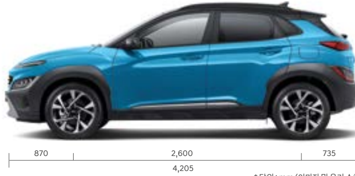
* 단위: mm (이미지 및 윤거 수치는 스마트스트림 가솔린 1.6 터보/가솔린 2.0의 18인치 타이어 기준) * ( ) 루프랙 선택 시 * N Line은 전장 4,215mm, 전고 1,560 (루프랙 선택 시 1,570)mm
