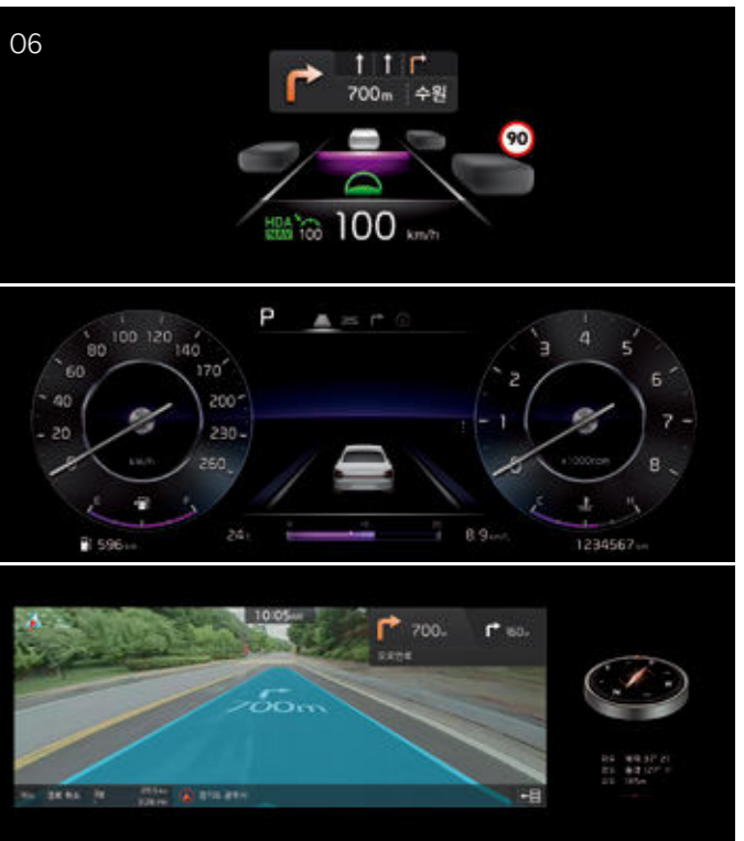
06_ 무선 업데이트 (OTA) 이더넷 고속 통신을 활용하여 내비게이션 정보뿐 아니라, 클러스터, 헤드업 디스플레이에 표시되는 정보까지 무선으로 자동 업데이트합니다.
