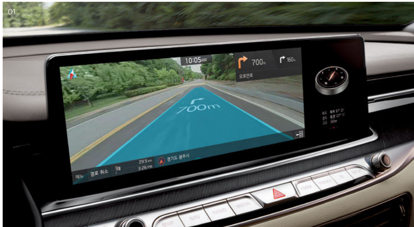
01_ 증강현실 내비게이션 실제 주행 영상 위에 안내 지점과 진출 방향이 표시되어 직관적으로 운행정보를 파악할 수 있습니다. 목적지 표시, 스마트 크루즈 컨트롤 등 다양한 정보를 세심하게 표현해줍니다.
