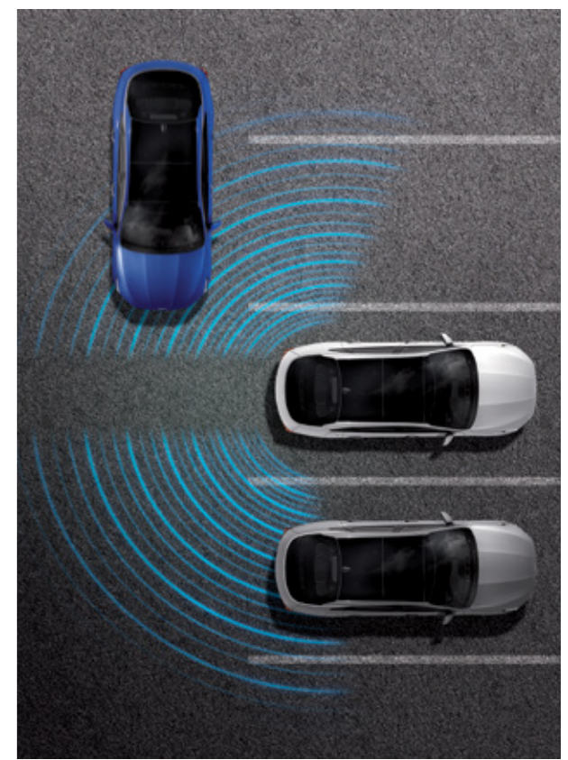
후방 교차 충돌방지 보조* 후진 중 좌/우측의 충돌 위험이 감지되면 경고를 해주고, 경고 후에도 충돌 위험이 높아지면 자동으로 제동을 도와줍니다.
