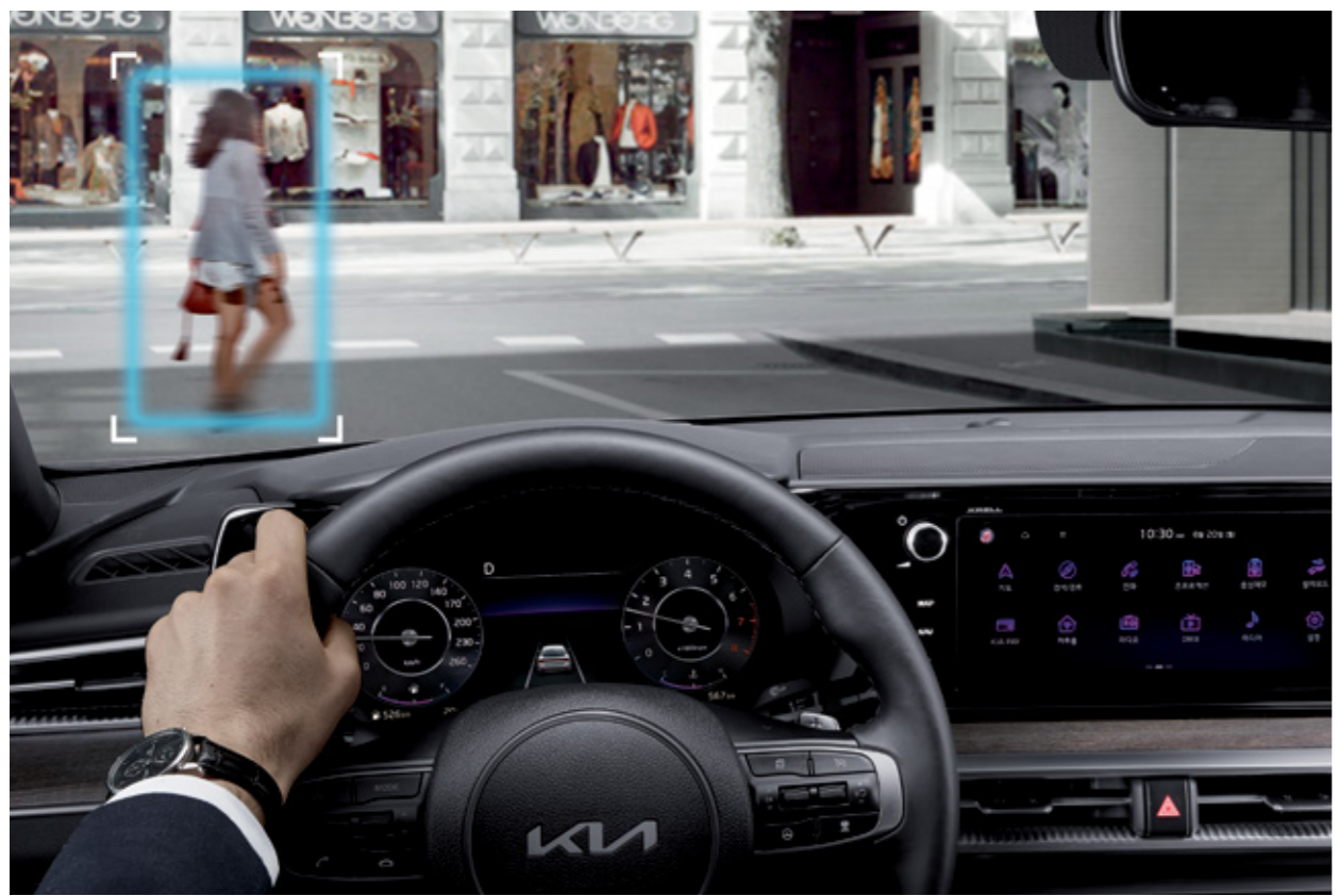
전방 충돌방지 보조 (차량/보행자/사이클리스트)* 차량, 보행자, 자전거 탑승자 등 전방 충돌 위험이 감지될 경우 경고를 해주고, 경고 후에도 충돌 위험이 높아지면 자동으로 제동을 도와줍니다.
