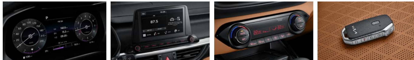
슈퍼비전 클러스터 (10.25인치 칼라 TFT LCD) 8인치 디스플레이 오디오 (GT 전용) 독립제어 풀오토 에어컨 스마트키 (원격시동 포함)
