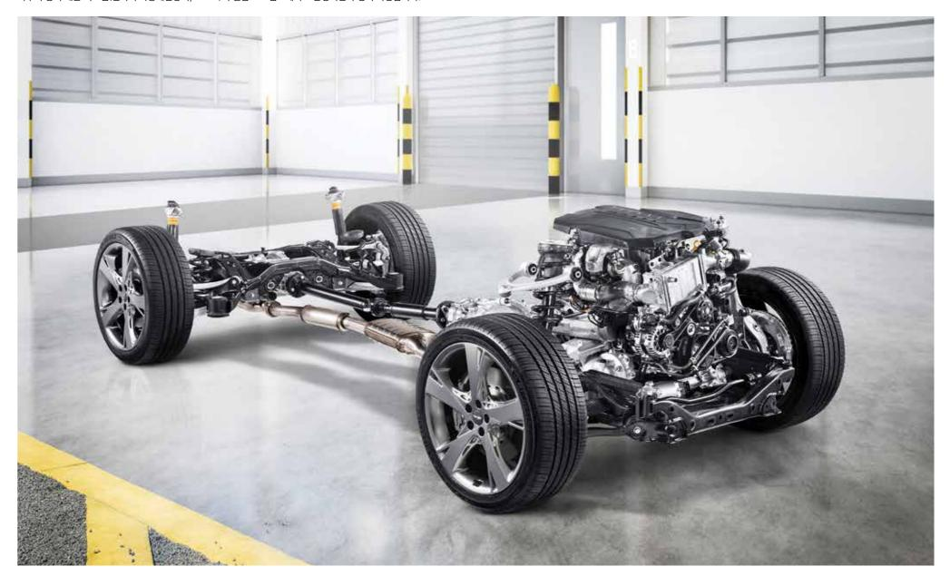
**신규 플랫폼 \_** 후륜구동 SUV에 최적화된 신규 플랫폼은 신규 서스펜션 구조로 주행 성능을 확보하고 경량화 기술 및 SUV 전용 골격 강화 구조를 통해 주행 강성을 확보하였습니다. 도어, 후드, 테일게이트에는 알루미늄 차체를 적용하고 차체 평균 인장강도를 대폭 증대하여 동급 최고 수준의 충돌 안전성 확보하고 승객실 주변에 핫스탬핑 강판을 확대 적용하여 승객실 최우선 안전을 강화하였습니다.
