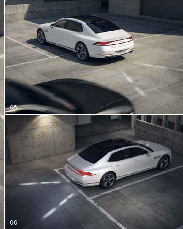
05. 06. 후방 교차 충돌방지 보조 _ 후진 중에 좌우측에서 다가오는 차량과 충돌 위험이 감지되면 경고를 보내고 위험도가 높아지면 자동으로 제동을 도와줍니다. 후진 가이드 램프 _ 차량 후진 시 가이드 조명을 후방 노면에 비춰 보행자와 주변 차량에게 차량의 후진 의도를 전달합니다.
