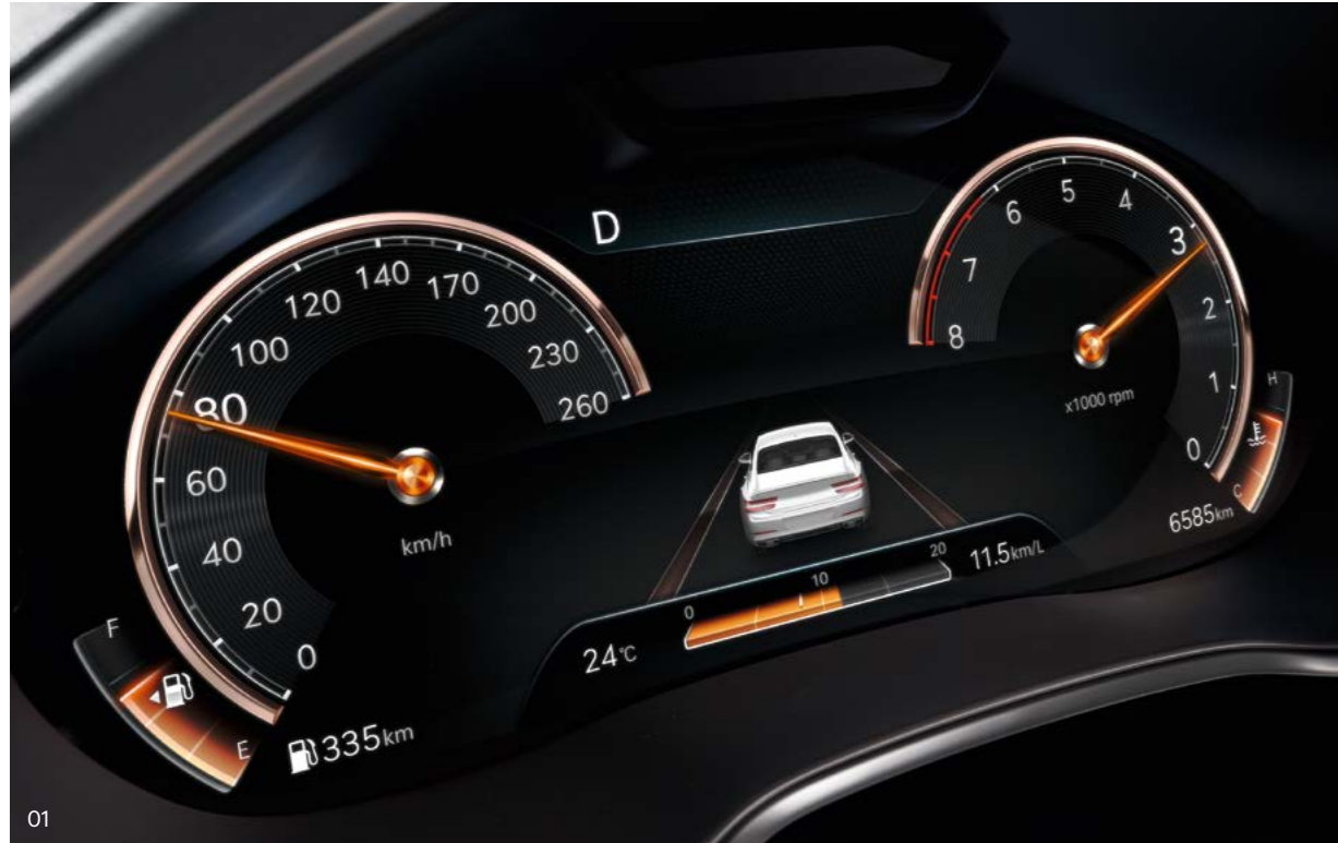
01. 12.3인치 3D 클러스터 _ 고해상도 대화면 TFT LCD의 3D 클러스터가 주행모드에 따라 차별화된 디자인과 콘텐츠 뷰를 제공합니다. 클러스터에 내장된 카메라로 운전자의 시선을 추적해, 운전자가 어떤 각도에서도 3D로 정보를 파악할 수 있도록 해줌으로써 시인성을 높입니다.
