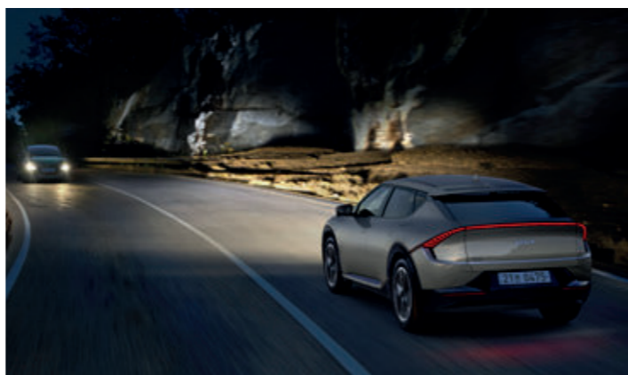
지능형 헤드램프 (IFS) 상향동 상태를 유지하여 운전자의 시야를 안전하게 확보하는 동시에, 마주 오는 전방 차량 영역의 빛을 부분적으로 차단해 대향차 운전자의 눈부심을 막아줍니다. 선행 차량 영역에도 동일하게 작동하며, 별도의 헤드램프 조작 없이도 시야 확보가 유리하기 때문에 야간 운전이 더욱 용이합니다.
