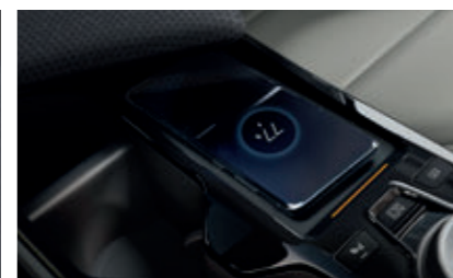
스마트폰 무선충전 시스템 센터콘솔 상단 트레이에 마련된 스마트폰 무선충전 시스템으로 스마트폰을 충전할 수 있습니다.
