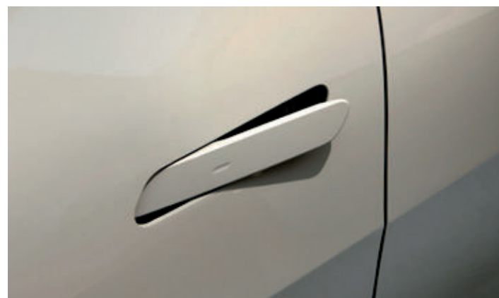
오토 플러시 도어 핸들 주차, 주행 시에는 도어 내측에 숨겨져 있다가 승하차 시 자동으로 팝업되는 오토 플러시 도어 핸들 적용으로 사용 편의성을 증대하고 심리스한 외관을 구현하였습니다.
