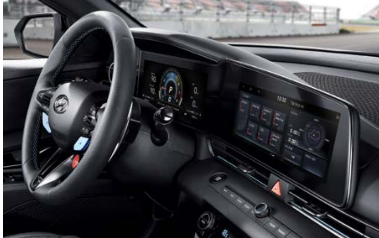
클러스터(10.25인치 컬러 LCD, N 전용 그래픽 포함) 10.25인치 내비게이션(N 그린 컨트롤 시스템 포함)
