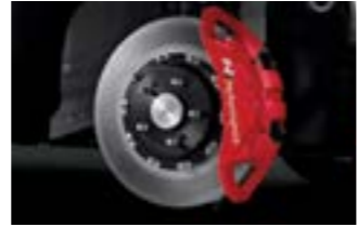
N 퍼포먼스 브레이크 시스템 (모노블록 4피스톤 캘리퍼, 볼팅타입 하이브리드 디스크) *휠 단품 구매 가능
