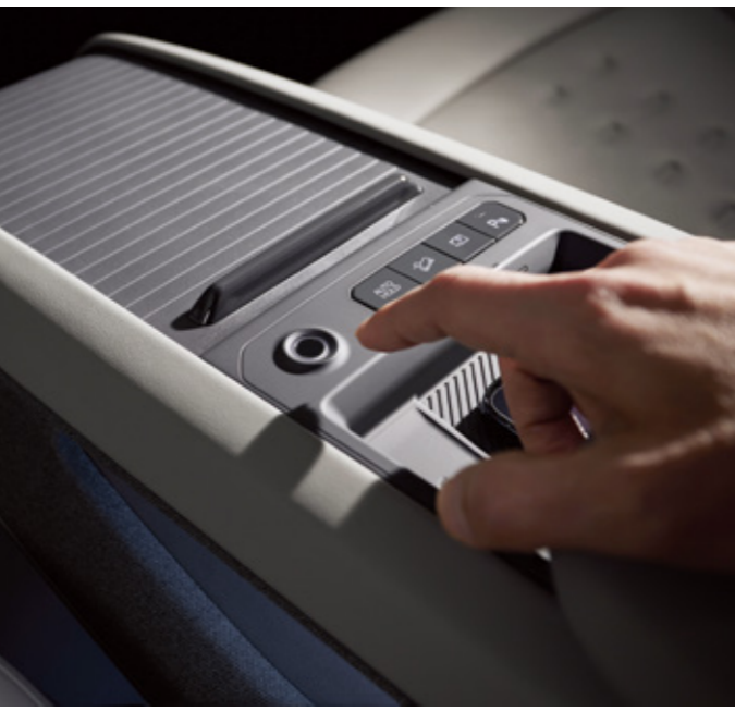
지문 인증 시스템 차량 내 간편 결제나 발레 모드 해제 시 필요한 인증 기능을 수행하고 지문 인식만으로 차량의 시동과 주행이 가능합니다.
