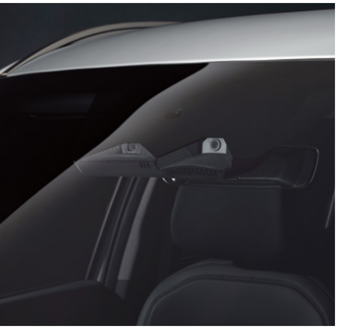
빌트인 캠 2 전/후방 고해상도 카메라를 통해 주/야간 화질이 우수하며, 영상 및 음성을 기록, 저장할 수 있습니다. 대용량 외장 메모리 카드 지원과 기아 커넥트 앱과의 연동을 통한 이벤트 발생 시 알림 기능 등의 커넥티드 서비스를 제공하며 GPS 차량 위치 등 상황 파악에 도움이 되는 정보를 기록하고 저장할 수 있습니다.
