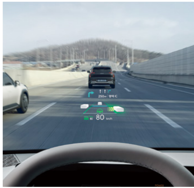
헤드업 디스플레이 12인치 고화질, 대화면 헤드업 디스플레이를 통해 클러스터 및 내비게이션의 주요 주행 관련 정보를 표시합니다.
