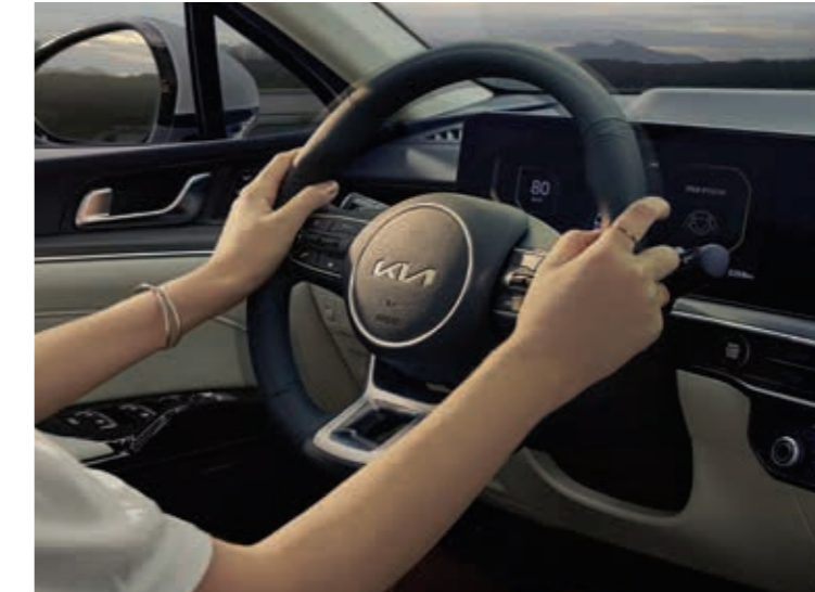
스티어링 휠 진동경고* 주행 중 전방, 후측방에서 충돌 위험이 감지되거나 운전자 주의 경고가 필요할 시 스티어링 휠 진동을 통해 직관적으로 위험 상황을 알려주고 더욱 안전한 주행을 도와줍니다.
